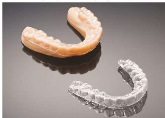
Рис. 1. Распечатанная на 3D-принтере модель и готовая отформованная каппа
